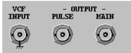
Las salidas funcionan del mismo modo que en el osciloscopio. Si pulsamos sobre ellas, variamos la sonda conectada. Las salidas se representan mediante el color rojo.
