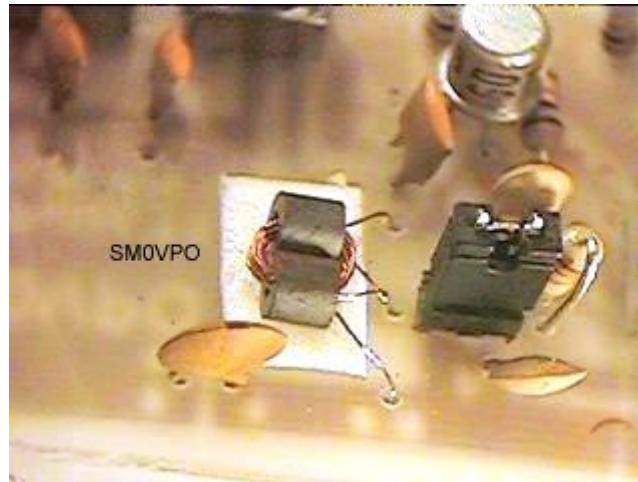
Detalle de T2 y del jumper de "Mod"
